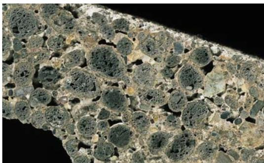
Sezione di un Lecablocco Bioclima. In evidenza il calcestruzzo Leca con struttura microporosa.
