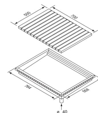
N.B. Tutti i sistemi di pavimentazione con vasca e griglia, sono inseriti nel pavimento, pertanto necessitano di un'altezza del massetto adeguata e devono essere sifonati.
