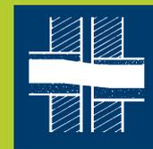
Geberit PE si distingue per la bassa conducibilità termica che comporta un basso coefficiente di dilatazione, ossia 0,2 mm/mk.
