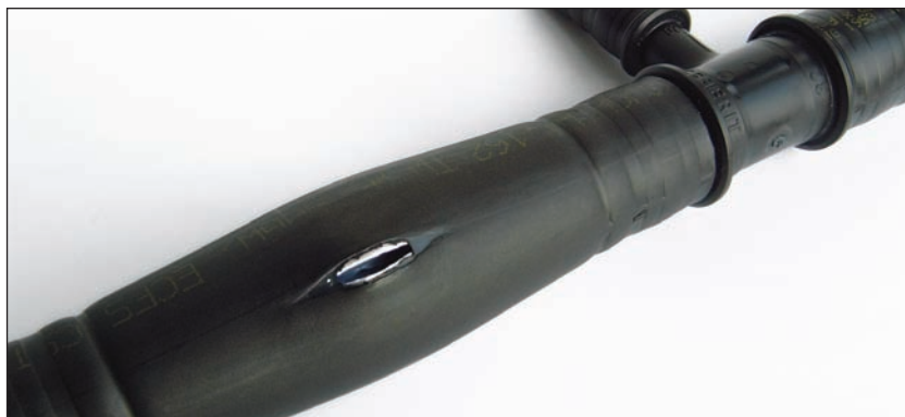
Test pressione a 120 bar
