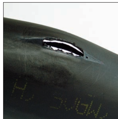
Oltre 120 bar, cede la parte centrale del tubo
