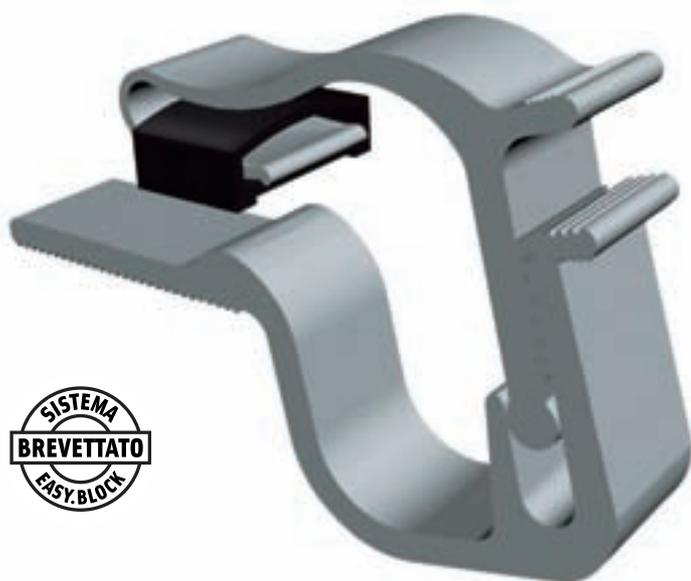
Innovativo sistema di fissaggio "EASY BLOCK" brevettato, massima rapidità e sicurezza nella posa, con il semplice impiego di una pinza e di una leva, in pochi secondi si può montare o smontare la cupola. Easy Block, con speciale disegno ergonomico, è costituito da due staffe in alluminio estruso ad elevata resistenza. L'originale sistema di fissaggio, senza la necessità di praticare alcun foro sulla cupola e sulla staffa, garantisce impermeabilità e massima durata.
