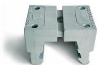
Per l'applicazione dei Moduli Fotovoltaici e degli accessori (linea vita, ecc...) il sistema DRYTEC® prevede l'applicazione della staffa Multiblock, in poliammide rinforzata vetro stabilizzata raggi UV, che oltre a fungere da base per tutti i componenti aggiuntivi è di semplice e veloce installazione.
