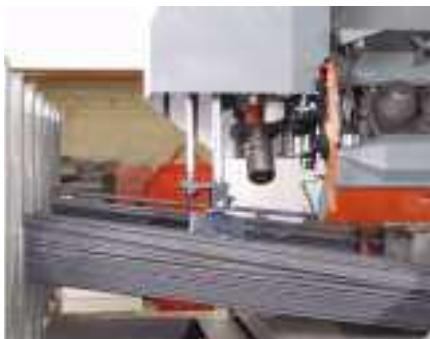
Caricatore Automatico Genius: permette di effettuare il caricamento delle barre in modalità completamente automatica, senza intervento dell'operatore.
