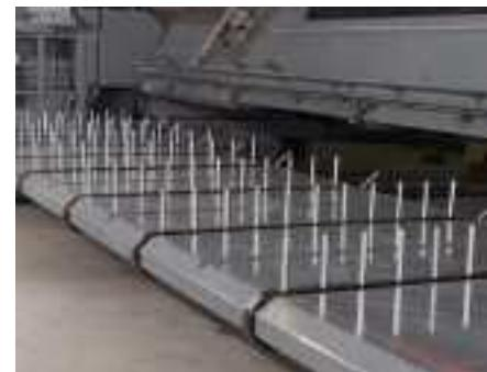
Per la raccolta dei sagomati, oltre al carrello motorizzato, è disponibile anche il carrello evacuatore, caratterizzato da alimentatori a catena e rack di stoccaggio.
