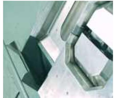
BAR WISER 26 è una potentissima sagomatrice-staffatrice a due teste di piega per la lavorazione del ferro in barre con capacità di lavorazione fino al Ø 26 mm, doppio Ø 20 mm o triplo Ø 12mm. Per le sue caratteristiche di flessibilità e potenza BAR WISER 26, è particolarmente indicata per i medio-grossi centri di sagomatura come impianto sostitutivo del più tradizionale banco di taglio e robot di piega, o in generale per quei centri che hanno come obiettivo la classificazione a bordo macchina.
