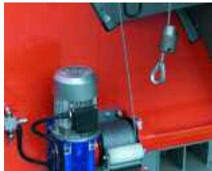
L'argano inserimento filo permette un veloce inserimento dei fili delle nuove bobine. (Bar Wiser MF).
