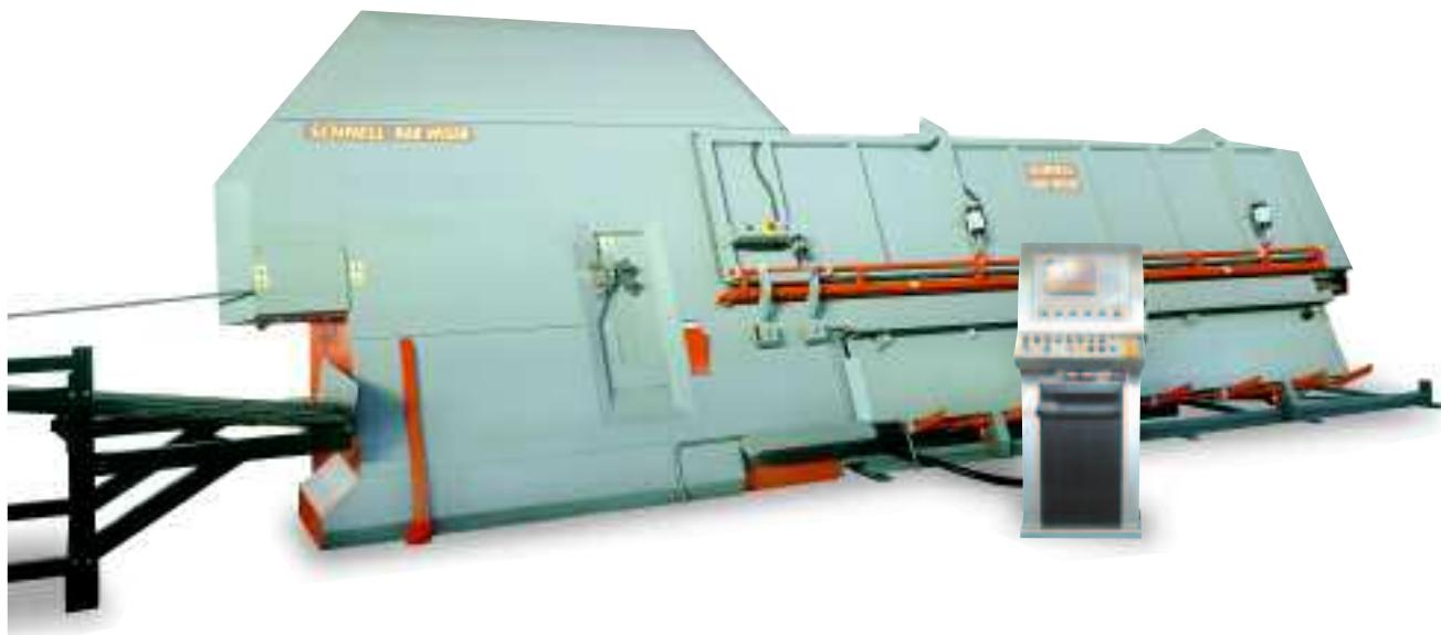
Bar Wiser S è caratterizzata dalla presenza di una linea di lavoro superiore e di una inferiore. Sulla linea superiore si realizzano le pieghe del lato destro del sagomato; sulla linea inferiore si realizzano le pieghe del lato sinistro. Ciò è reso possibile dalla presenza del bancal reccoglibarre, dalla pinza di bloccaggio e dalla battuta mobile di misurazione.
