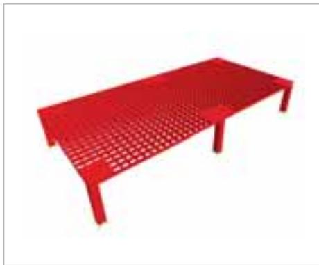
Modellazione shell+solid struttura indeformata.
