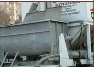
**L'inoltro e la distribuzione in quota del conglomerato a base di perlite espansa Perlিমix® avvengono mediante pompaggio.**
