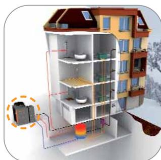
Esempio di applicazione di pompa di calore ad assorbimento E<sup>3</sup> A con caldaia a condensazione AY 120 Condensing, collegata ad impianto a pannelli radianti e fan-coils, per riscaldamento e produzione di acqua calda sanitaria.
