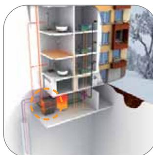
Esempio di applicazione di pompa di calore ad assorbimento E<sup>3</sup> GS con sonde geotermiche, collegata ad impianto a pannelli radianti e fan-coils, per riscaldamento e produzione di acqua calda sanitaria.
