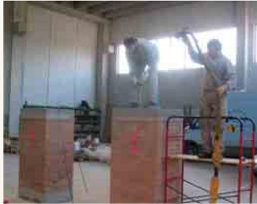
A tale scopo sono stati realizzati due provini di muratura di dimensioni circa 900x630x1700 mm (Lunghezza x Larghezza x Altezza) costituiti ciascuno da un supporto di base, una parte centrale in muratura a sacco e da un
