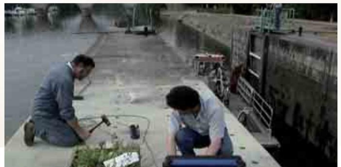
Le prove comparative, realizzate prima e dopo il trattamento con resina espandente, hanno evidenziato tutte un aumento della rigidità in tutti i punti misurati. **Mediamente l'aumento è stato del 23% con picchi del 73% nelle zone più degradate.**
