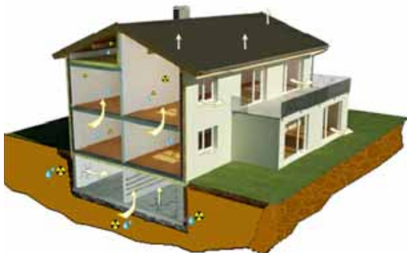
Pericolo del gas Radon e dell'umidità di risalita all'interno di un abitazione costruita con una fondazione tradizionale.
