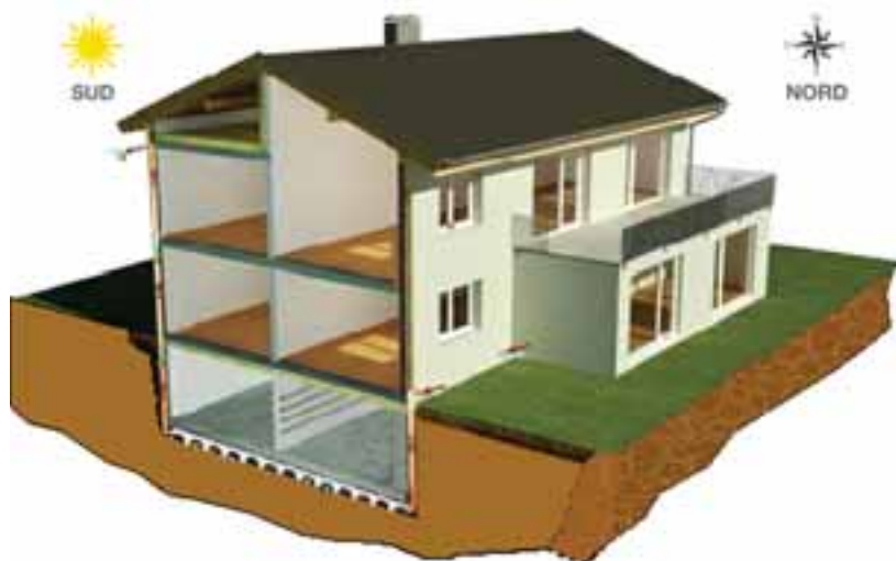
Abitazione costruita con una fondazione ventilata IGLÙ®.
