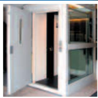
Piattaforma elevatrice idraulica con portate da 250, 350 o 500 kg. Disponibile con fossa 100 mm, testata 2450 mm e con struttura portante opzionale sia per interno edificio che esterno. Soluzione ideale per unità abitative unifamiliari o in situazioni di strutture e servizi per la collettività, specialmente in presenza di anziani o persone disabili.
