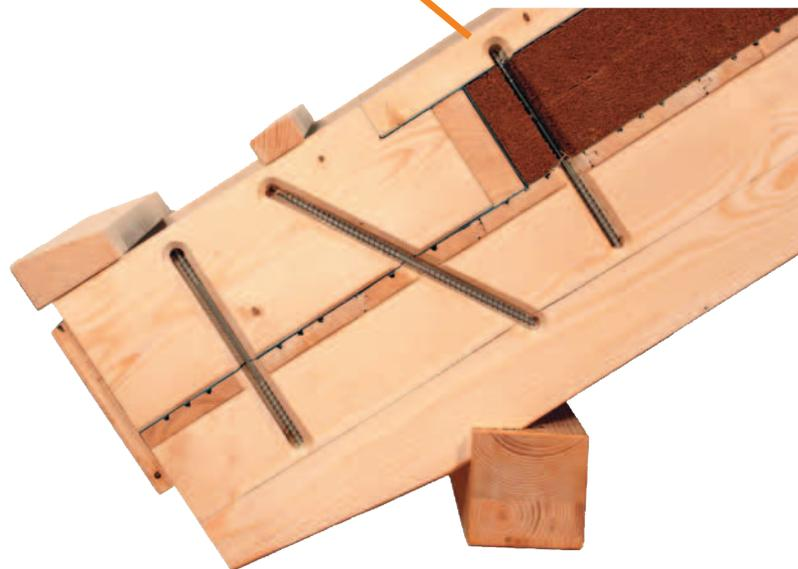
Le fodere vengono semplicemente spinte nella falda del tetto e possono essere quindi perfettamente isolate negli spazi risultanti sotto gli assi di spinta. Questa possibilità costituisce un grande vantaggio proprio per la costruzione di case passive o in generale di edifici ad alto isolamento. Le distanze delle viti distanziatrici nella falda del tetto vengono dimensionate con il software HECO® HCS, così come le lunghezze delle viti e il dettaglio di gronda.
