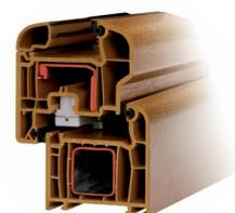
La Serie **Sigma** ha **5 camere di serie** da 70 mm (telaio e battente) a **2 guarnizioni** in materiale elastometrico termoplastico EPDM (che permette un ottimo funzionamento combinato di telaio e anta). La vetrocamera ha **spessore 4/15/4**.
