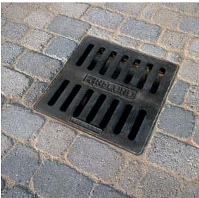
Caditoia in ghisa sferoidale GJS-500-7 (EN 1563), costituita da telaio di forma quadrata senza aletta perimetrale esterna, per consentire un perfetto accostamento della pavimentazione.
