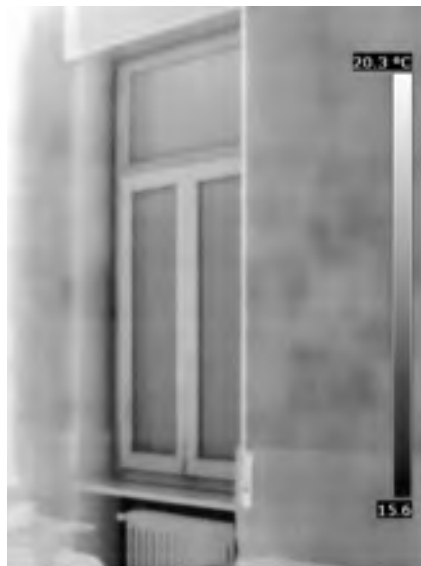
Fig. 3 - Muratura disomogenea perché realizzata parzialmente con elementi lapidei.
