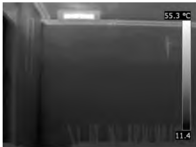
Fig. 4 - Stratificazione delle temperature in una mensa scolastica riscaldata con sistemi ad aria a soffitto.
